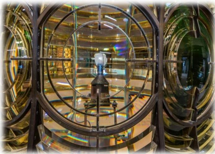
Der Leuchtturm Rubh Re steht auf Klippen mit Blick über die Meerenge „the Minch“. Am 15. Januar 1912 wurde dessen Lampe zum ersten Mal angezündet. Die beeindruckende Fresnellinse drehte sich alle 30 Sekunden, angetrieben von einem Uhrwerk, das Tag und Nacht aufgezogen werden musste. Als der Leuchtturm 1986 automatisiert wurde, wurden die Linse, die Lampe und der Mechanismus gerettet - zusammen mit dem Nebelhorn, das sich heute vor dem Museum befindet.
